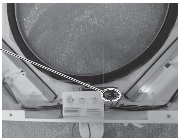
8. 拧下8个螺丝，然后拆下4个触控板固定钣金和触摸传感器。
